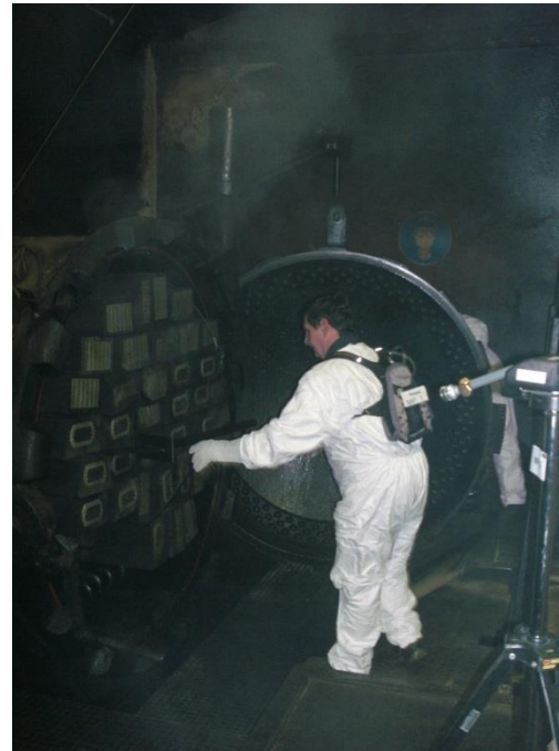
Holztränk- imprägnierung mit Creosote (2011)
